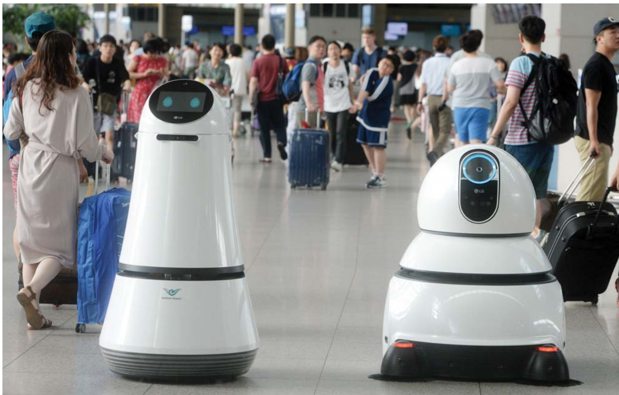
안내도 청소도 맡아서 '척척' 21일 오전 인천국제공항 출국장에서 LG전자 안내로봇(왼쪽)과 청소로봇이 움직이며 각각 항공편 등 정보제공과 청소를 하고 있다. LG전자는 이날 인천국제공항에 청소로봇과 안내로봇 각각 5대를 배치하고 시범서비스를 시작했다. LG전자의 안내로봇과 청소로봇은 공항 곳곳을 돌아다니며 공항 이용객들에게 안내서비스를 제공하고 실내 공간을 청소한다
