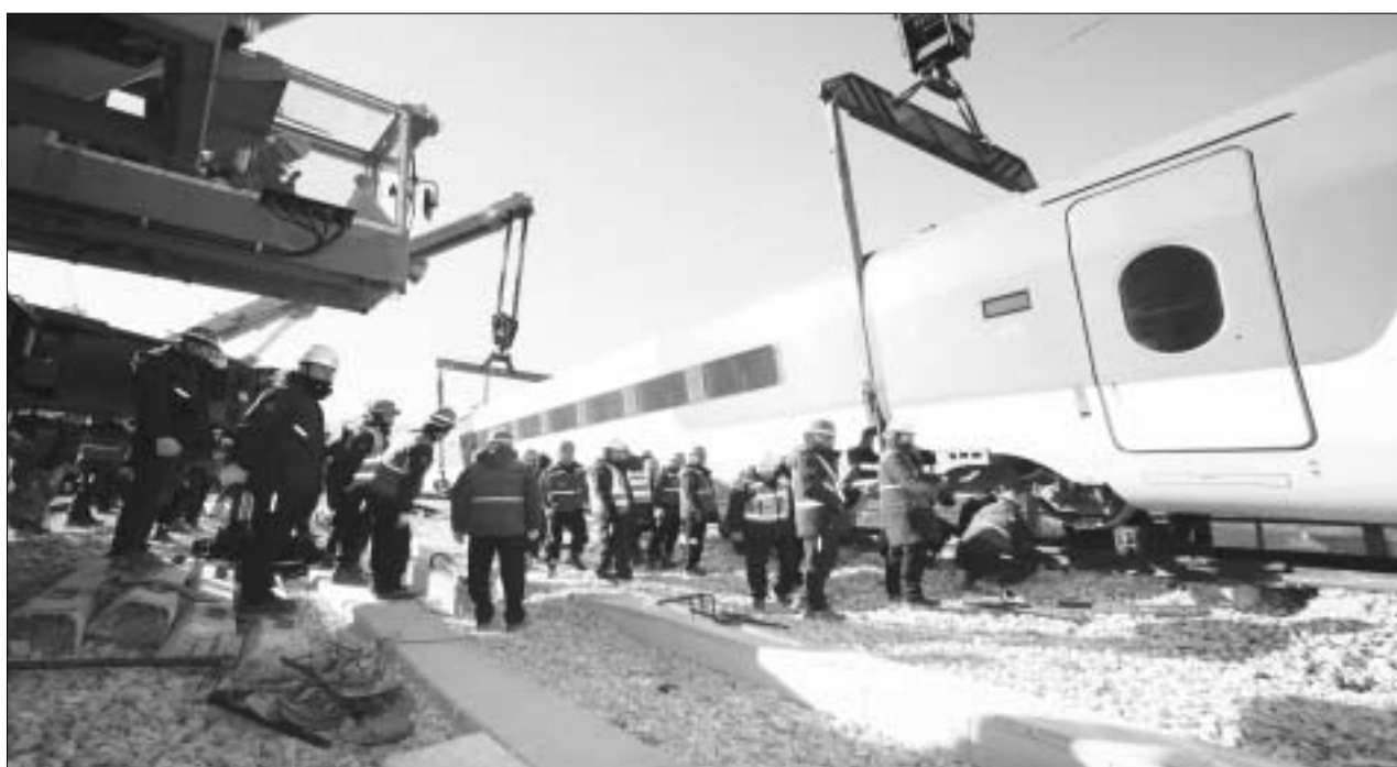
강릉 열차사고 수습 9일 오후 코레일 관계자들이 전날 오전 7시33분에 고속열차가 탈선한 강원도 강릉시 운산동 KTX 강릉선 열차사고 현장에서 기중기로 객차를 들어올리는 작업을 하고 있다.
