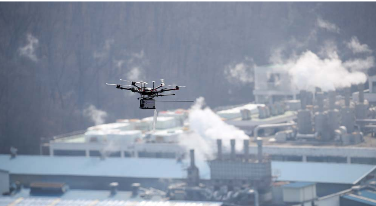
드론으로 미세먼지 배출 공장 단속...환경부 국립환경과학원과 수도권대기환경청 미세먼지 감시팀이 21일 경기 안산시 반월공단에서 오염물질 측정이 가능한 드론을 이용해 미세먼지 배출사업장 단속을 진행하고 있다.
