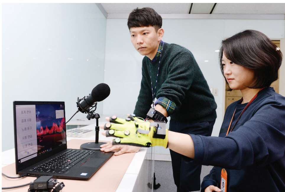
ETRI 신승용 선임연구원(왼쪽)과 정승은 선임연구원이 촉각 피치 시스템으로 진동을 통해 정확한 음정을 파악하는 훈련 과정을 시연하고 있다. ETRI 신승용 선임연구원(왼쪽)과 정승은 선임연구원이 촉각 피치 시스템으로 진동을 통해 정확한 음정을 파악하는 훈련 과정을 시연하고 있다.
