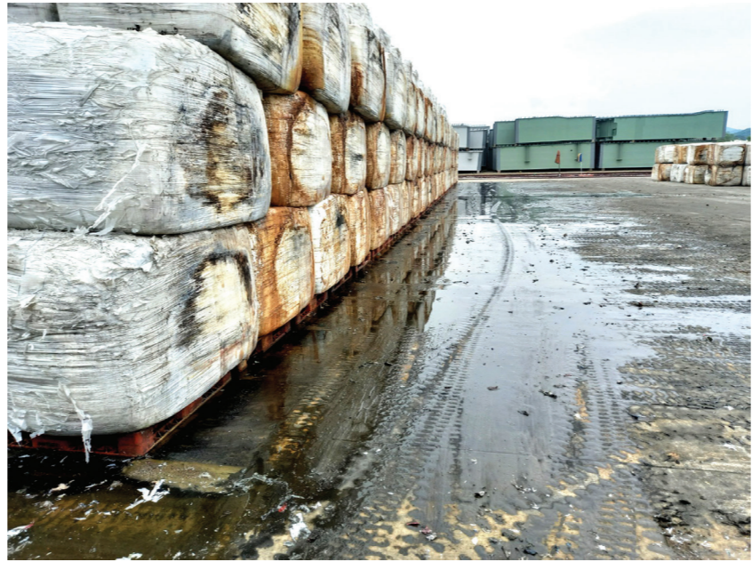
사진은 지난 6월 10일 촬영된 전남 장성군 물류센터 내 SRF(고형연료) 임시 야적장. 6일간 비가 오지 않았는데도 고품연료 더미에서 새어 나온 시커먼 침출수 때문에 바닥이 흥건히 고여 있다. (사진=나주시 제공)
