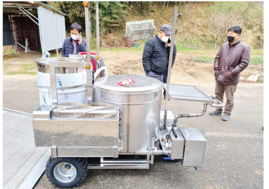
사진은 수평 운반차에 꿀을 뜨는데 필요한 ‘탈봉기·채밀기·발전기·비상 차단기’가 모두 탑재돼 있는 채밀대차 모습. 양봉농가의 인력난 해소에 큰 도움이 된다.
