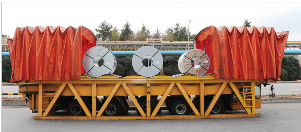
위 사진은 자동복포장치가 설치된 팔레트를 ET카(Elevation Transporter)가 싣고 있는 모습.
